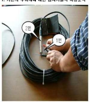
**테스트 결과:** 수위계의 몸체와 수위계 연결선의 접지선과 도전 상태를 측정 한 결과 절면(전기적 으로 연결이 안됨) 상태로 측정이 되었음. (1번↔2번 절연)
