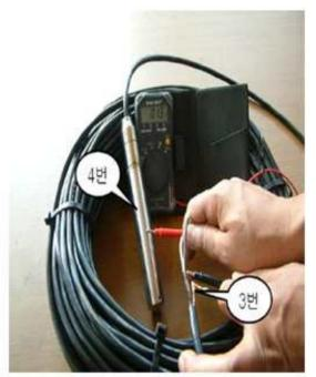
테스트 결과: 수위계의 몸체와 수위계 연결선의 접지선과 도전 상태를 측정한 결과 전기저항 값 1.3Ω의 상태로 연결이 된 것이 확인 됨. (1번↔2번 연결 됨)
